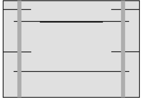
图 2 238 U 裂变电离室 MC 模拟几何模型示意图 Fig. 2 Geometric structure of 238 U fission chamber used for MC simulation
