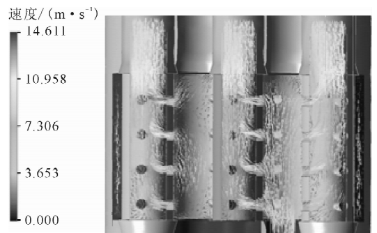
图11 小栅板联箱轴向流速分布
