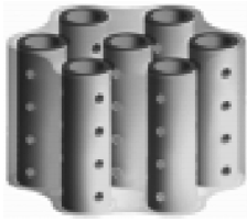
图 7 小栅板联箱内部流道结构
