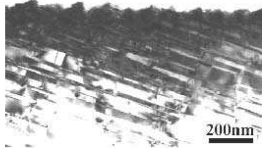
图 6 HgCdTe 薄膜材料中的孪晶
