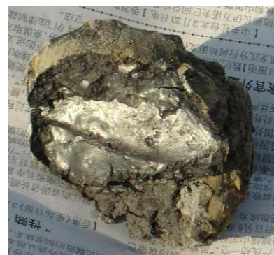
图 1 张性裂隙中的黑色软淤泥沉积(05 - 水 2, 钻孔深度 336 m)
