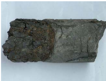
图3 破碎岩石与相对完整岩石之间以滑动层面相接触(05-水1钻孔,深507.35~509.35 m)
