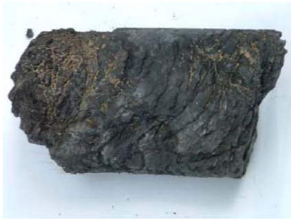
图2 揉皱式压性劈理(05-水1钻孔,深484.36 m)
