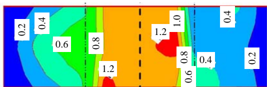
图 9 模型地表沉降第 3 阶段末等值线(单位: mm)
