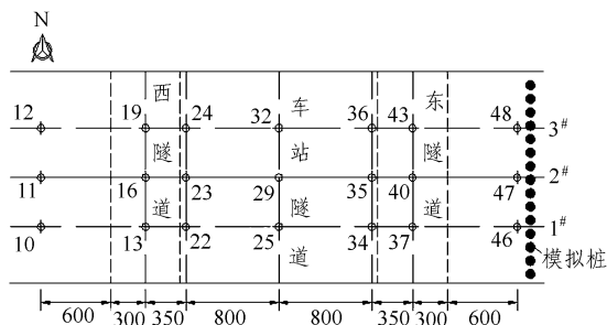
图 4 模型地表沉降点平面布置图(单位: mm)
