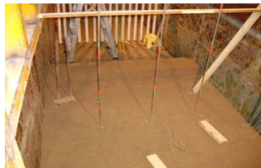
图 3 模型中多点位移计埋设
