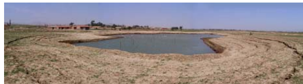
图 1 浸水中期试坑周围的地表形态
