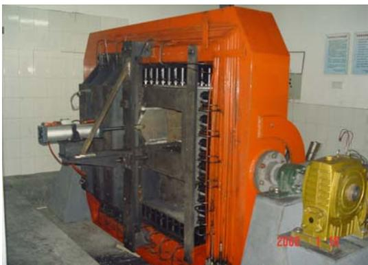
图 5 煤与瓦斯突出试验前状态图
