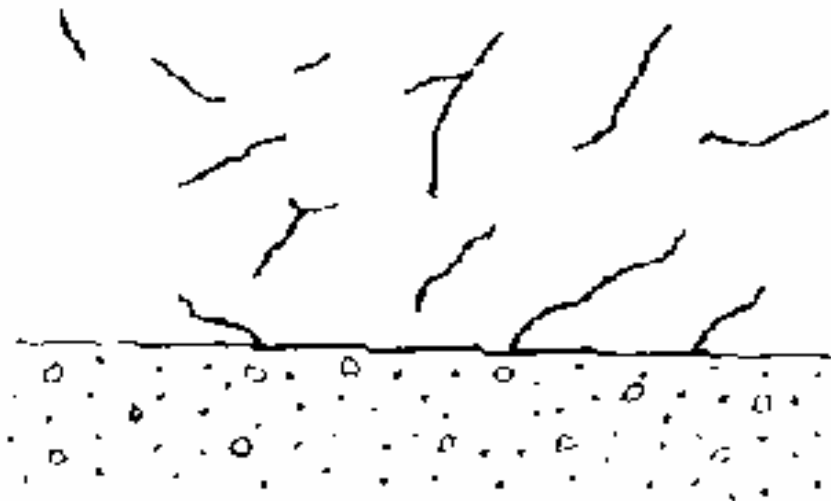
水泥异常凝结引起的裂缝
