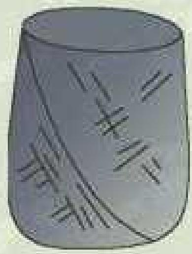
铸铁受压后形成鼓形，具有明显的塑性变形
