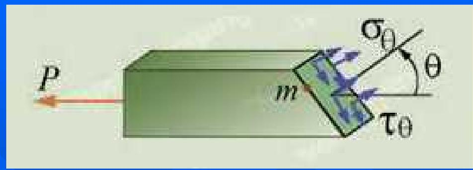
过同一点的不同方向的截面上的应力各不相同，此即应力的面的概念。
