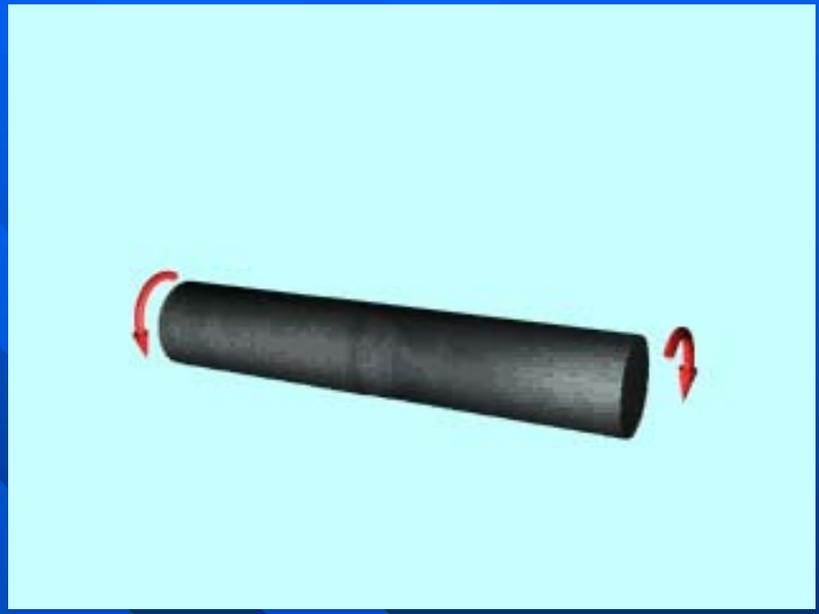
**问题：**为什么铸铁扭转时会沿  $45^\circ$  螺旋面断开？
