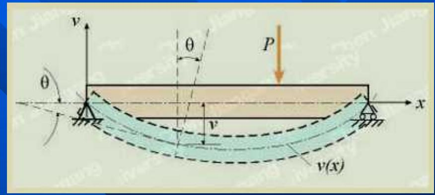
**注意:** 挠曲线的近似微分方程仅适用于小变形的平面弯曲问题。
