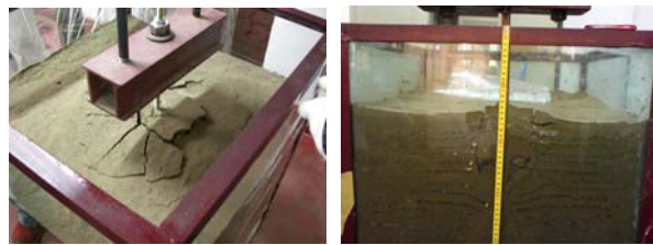
(1) 全模试验(土表破坏形态) (2) 半模试验(土中破坏形态)
