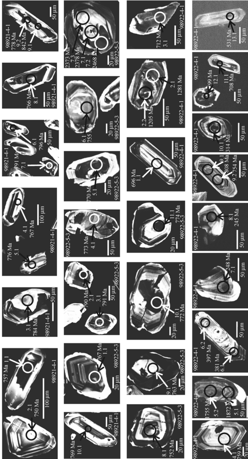
图 2 样品中部分铅石在阴极发光下的形态与结构及部分分析点示意图
