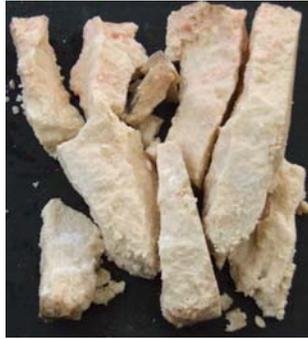
图 8 礁灰岩破坏后照片
