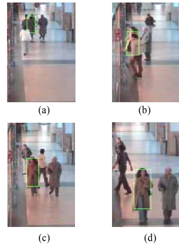
图 4 复杂情况下(遮挡、光照、尺度变化)的目标跟踪
