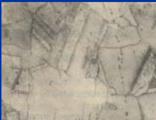
工业纯铁 孪晶 100倍
