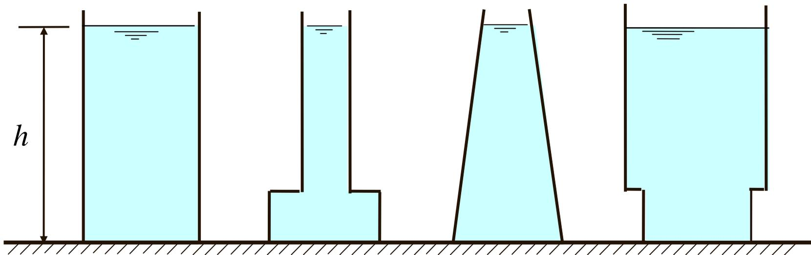
水深相同，通底面积相同，桶底所受水压力相同，整桶所受水的作用力（桶内水的重量）不同。
