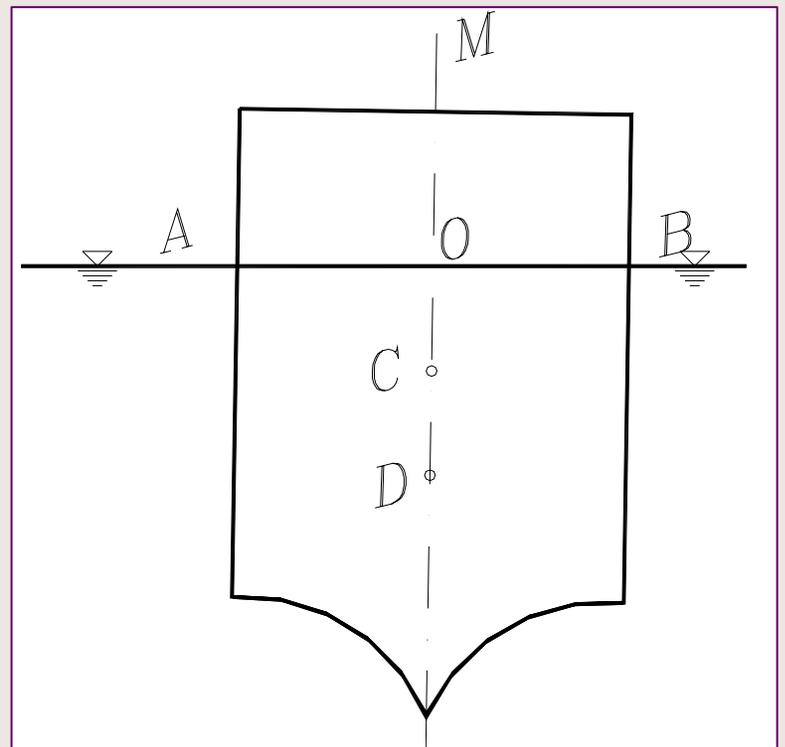
•定倾中心：浮体倾斜时，浮轴与浮力作用线的交点M。
