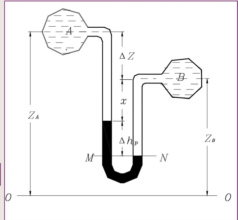
例2-4 已知 $h=5\text{m}$ , 求A点的绝对压强, 相对压强及真空度.
