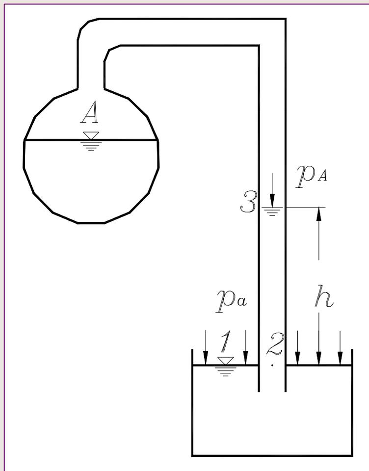
例2-5 已知压力计液面高差 $h_3=0.03\text{m}$ ，其它如图。求(1)压力表读数； (2) A、
