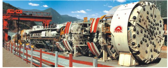
图 7 开敞式(TBM)硬岩掘进机
