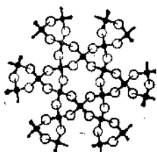
图 9.1.1 \beta -石英的结构
