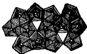
图 7.5 \alpha\text{-U}_3\text{O}_8 的晶体结构 (图中小球代表五角双锥的顶点)
