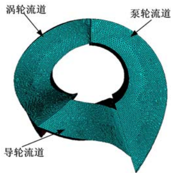
图 3 液力变矩器计算流道网格模型
