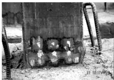
图 5 典型的试件破坏形态
