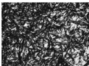
图1 齿轮表面渗碳层组织 400×
