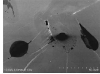
图2 沉积在甜菜碱表面上 Ni 膜的 SEM 图像
