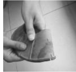
图6 老化的防污闪辅助伞裙
