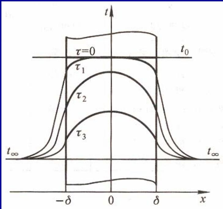
厚度  $2\delta$  的无限大平壁， $\lambda$ 、 $a$  为已知常数； $\tau=0$  时温度为  $T_0$ ；突然把两侧介质温度降低为  $T_\infty$  并保持不变；壁表面与介质之间的表面传热系数为  $h$ 。两侧冷却情况相同、温度分布对称。中心为原点。
