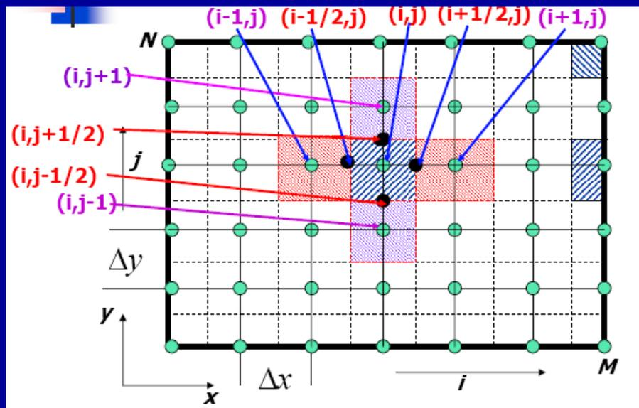
**网格划分** 对求解域作离散化处理，以网格线的交点作为需要确定的温度值的空间坐标，称为节点。
