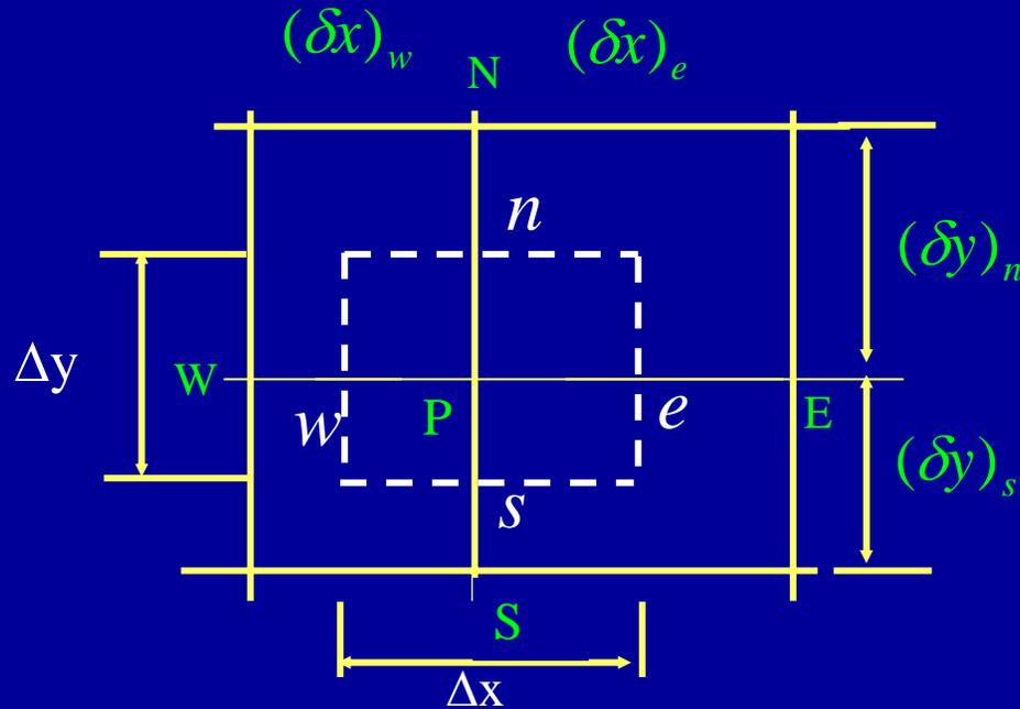
每一个节点都可以看成是以它为中心的一个小区域的代表，这个小区域称为**控制容积（或控制）体**。以节点**P**所示的控制容积为例，相邻节点用角注大写字母**E**、**W**、**S**、**N**表示，相邻控制容积交界面用角注小写字母**e**、**w**、**s**、**n**表示；控制容积尺寸用  $\Delta x$ 、 $\Delta y$  表示，节点间距用  $\delta x$ ， $\delta y$  表示。
