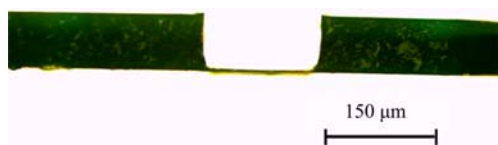
图 6 薄膜微槽 CCD 显微放大 200 倍侧视图
