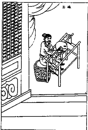
图 4 《天工开物》1637年初刻本 第123图（此图甚简略。砣 具下应有接水和砂的槽，砣 上应有罩，防止泥砂飞溅。）
