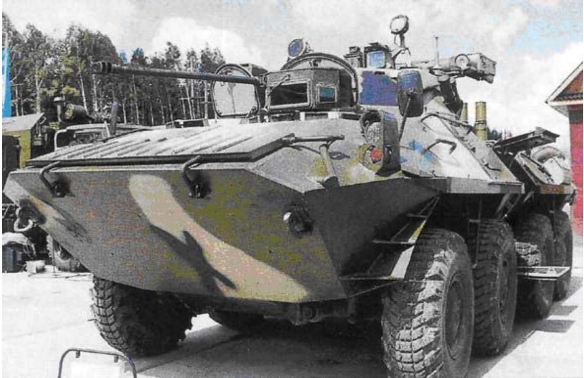
1994 年，俄罗斯研制出 BTR-90 (8×8) 装甲输送车，但至今尚未正式生产。该车的装甲防护能力得到较大增强，车体正面可防 14.5 毫米枪弹，车体底甲板为 V 形结构，增强了对反坦克地雷的抵御能力。战斗全重增加到 17 吨，安装了 BMP-2 步兵战车的炮塔，武器系统除 30 毫米机关炮外，又增装了 2 具 AT-5 反坦克导弹发射器，增强了远距离对坦克作战的能力。
