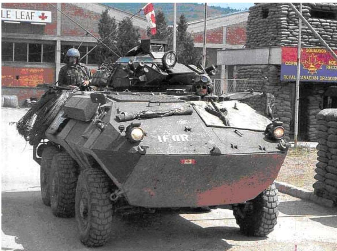
加拿大也是轮式装甲车的生产大国，主要是利用瑞士莫瓦格公司的“锯脂鲤”装甲车技术在本国形成生产能力。1977年至1982年，加拿大通用汽车公司利用“锯脂鲤”I型的技术为本国陆军生产了491辆“灰熊”（6×6）两栖装甲输送车。该车战斗全重10.5吨，乘、载员为9人，装有2挺12.7毫米机枪。其中195辆火力支援车型装有1门76毫米火炮。1982年，通用汽车公司开始利用“锯脂鲤”I型技术为美国海军陆战队生产LAV-25（8×8）装甲车；1993年，开始为加拿大陆军生产LAV-25装甲侦察车。
