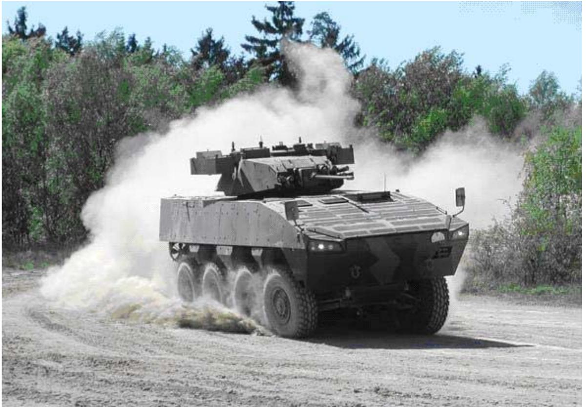
2004年5月，芬兰帕特里亚公司开始向波兰国防部交付首批2辆模块化装甲车，波兰军队将其编号为XC-360P。该车采用先进的模块化设计，战斗全重24吨，载员12人，可根据需要选装不同的武器系统。波兰总共订购了690辆，包括指挥车、装甲抢救车、自行火炮、工程支援车、工程侦察车、医疗救护车和三防车等，所有车型均具有水上浮渡能力。
