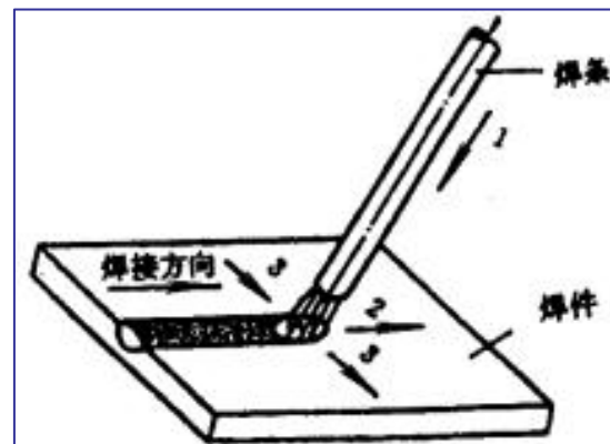
平焊焊条角度和运条基本动作
