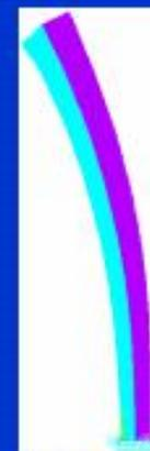
两根热膨胀系数不同的棒焊接在一起，图示为加热后的变形。
