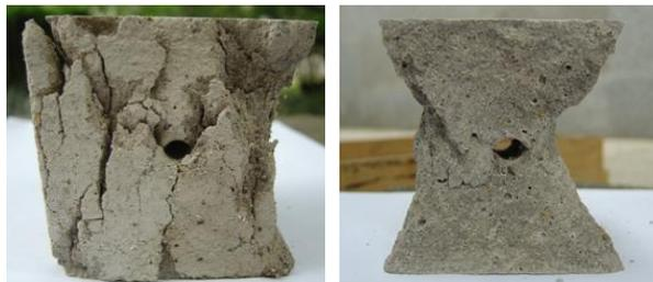
(a) 疲劳破坏后形态 (b) 剥离碎片后形态
