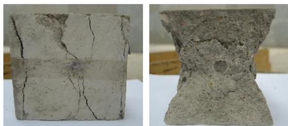
(a) 疲劳破坏后形态 (b) 剥离碎片后形态
