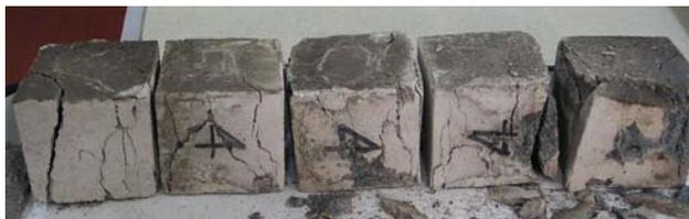
图 5 完整试样的疲劳破坏形态
