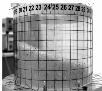
图2 颗粒隆起波形图( f = 40 Hz)
