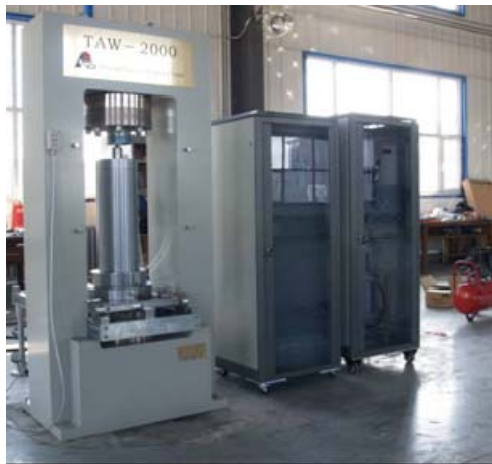
图 4 TAW - 2000 岩石三轴试验机
