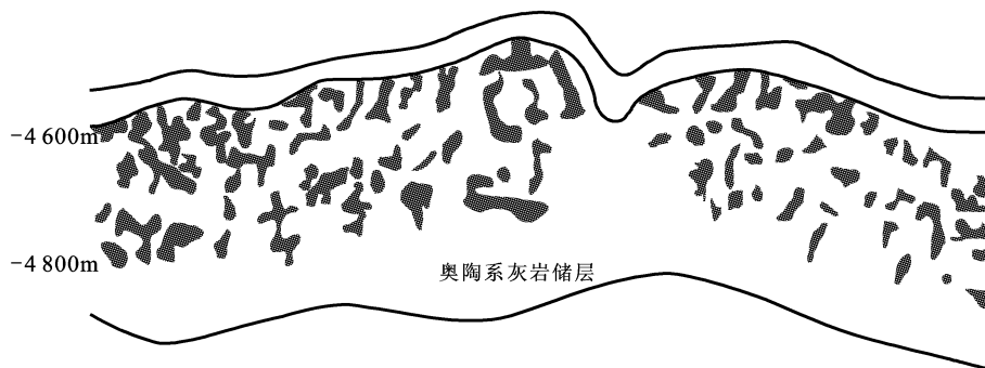
图 7-3 塔河油田油藏模式图(张希明,2001,有改动) (阴影部分为含油孔洞;储层中的裂缝分布未标注)
