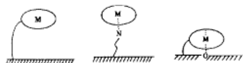
图 2 固载化 MPc 的结构示意图 Fig.2 The schematic structure of supported MPc
