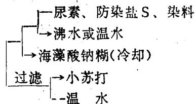
(4) 主要工艺参数：速度 40~50 米/分，蒸化温度 108°C，蒸化时间 5 分钟。
