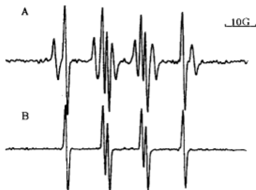
图 1 (A) SSN/ DMPO/ 水体系和 (B) SSN/ CdS/ DMPO/ 水体系经光照后所得之 ESR 谱
