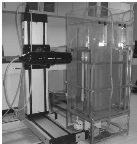
图 2 LDV 测速优化膜反应器实验装置
