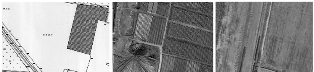
图 3 监测区土地整理后的砖厂平整为耕地 (左:土地利用规划设计;中:前时相遥感图像(1:2 000 航片);右:后时相遥感图像(QB 数据))
