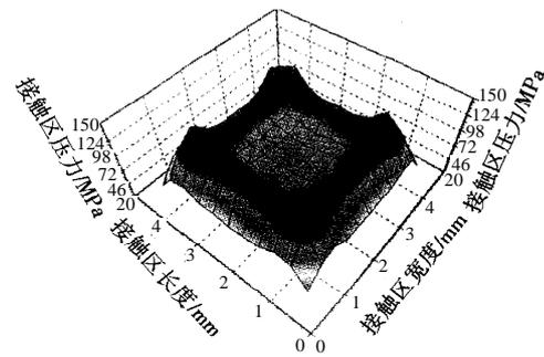
图3 接触区压力分布(z=5 mm)
