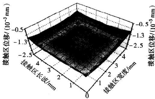
图2 物体A接触面位移(z=5 mm)
