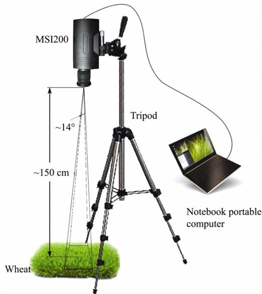
图 1 MSI200 成像光谱采集示意图
