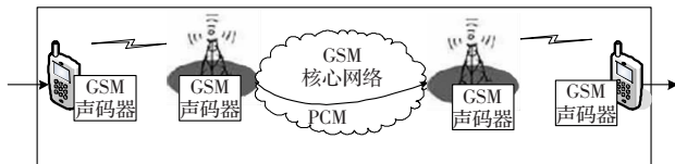
图1 GSM 系统级联声码器黑箱信道模型
