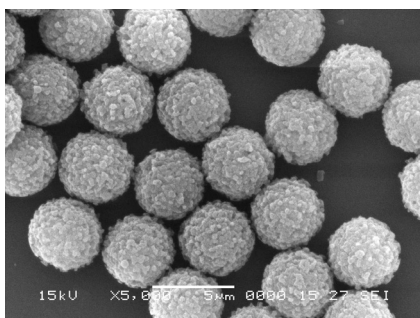
图 1 多孔 St/DVB 共聚微球的 SEM 照片 Fig.1 The SEM image of porous St/DVB microspheres
