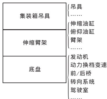
图 1 集装箱正面吊运机的基本模块
