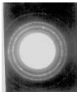
图 5 实验 2 的一个镍微粒 SAD 图像
