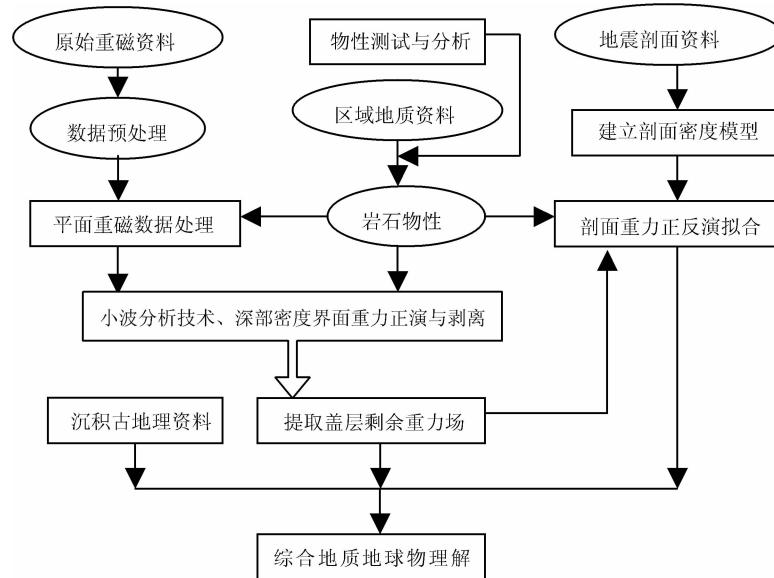
图 2 沉积相预测的综合地球物理研究流程
