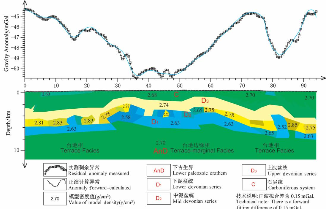
图5 AA'南北向地震剖面上重力正反演拟合结果
