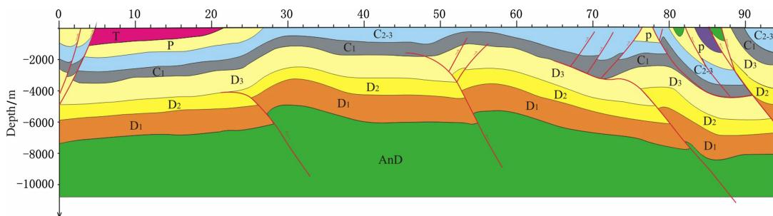
图 4 AA' 地震剖面构造解释图
