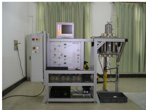
图 5 蠕变试验设备 Fig.5 Device for creep test
